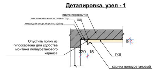
Мин. опуск ГКЛ в нишах для штор определяется индивидуально, с учетом жесткости конструкции в местах крепления ползьев штор.
